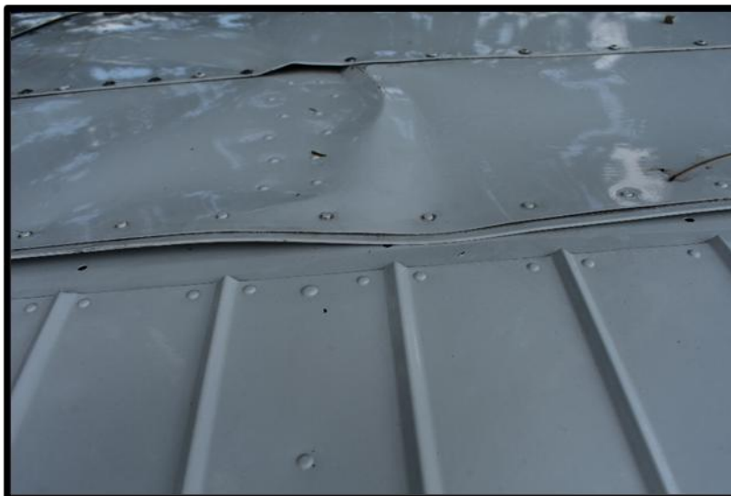
Fotografía No. 9 Plano derecho de la aeronave corrugado por el golpe.
