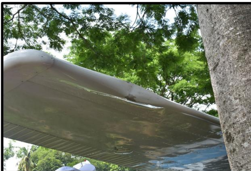
Fotografía No. 8 Daños en el borde de ataque del ala derecha de la aeronave.
