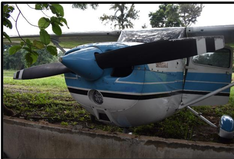
Fotografía No. 11 Daños en el spinner de la hélice de la aeronave.
